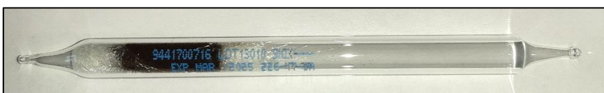
Figure 17 : Support de prélèvement Hopcalite, mesure du mercure
